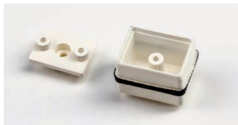
**Шаг 1.** Соберите бачок омывателя. Для этого закрепите основание на нижней стороне бачка омывателя. Для фиксации деталей используйте винт 1,7×4 (AP). После сборки бачка на его нижней поверхности должны выступать два крепежных штифта для дальнейшего монтажа на брызговик крыла.
