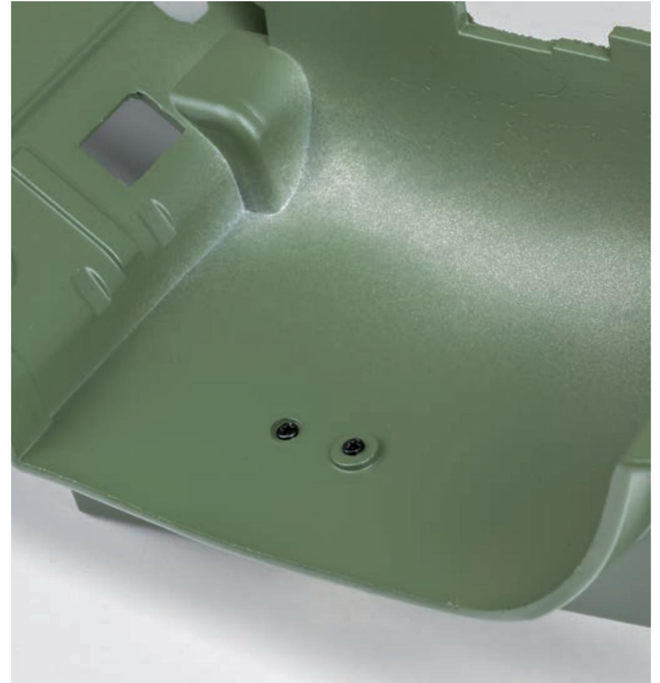
**Шаг 3.** Установите бачок омывателя на брызговик переднего левого колеса модели (в передней части пола кузова). Совместите крепежные отверстия и зафиксируйте бачок с нижней стороны брызговика двумя винтами 1,5×4 (ВР). При правильной установке прилив на крышке бачка должен располагаться с внешней стороны.
